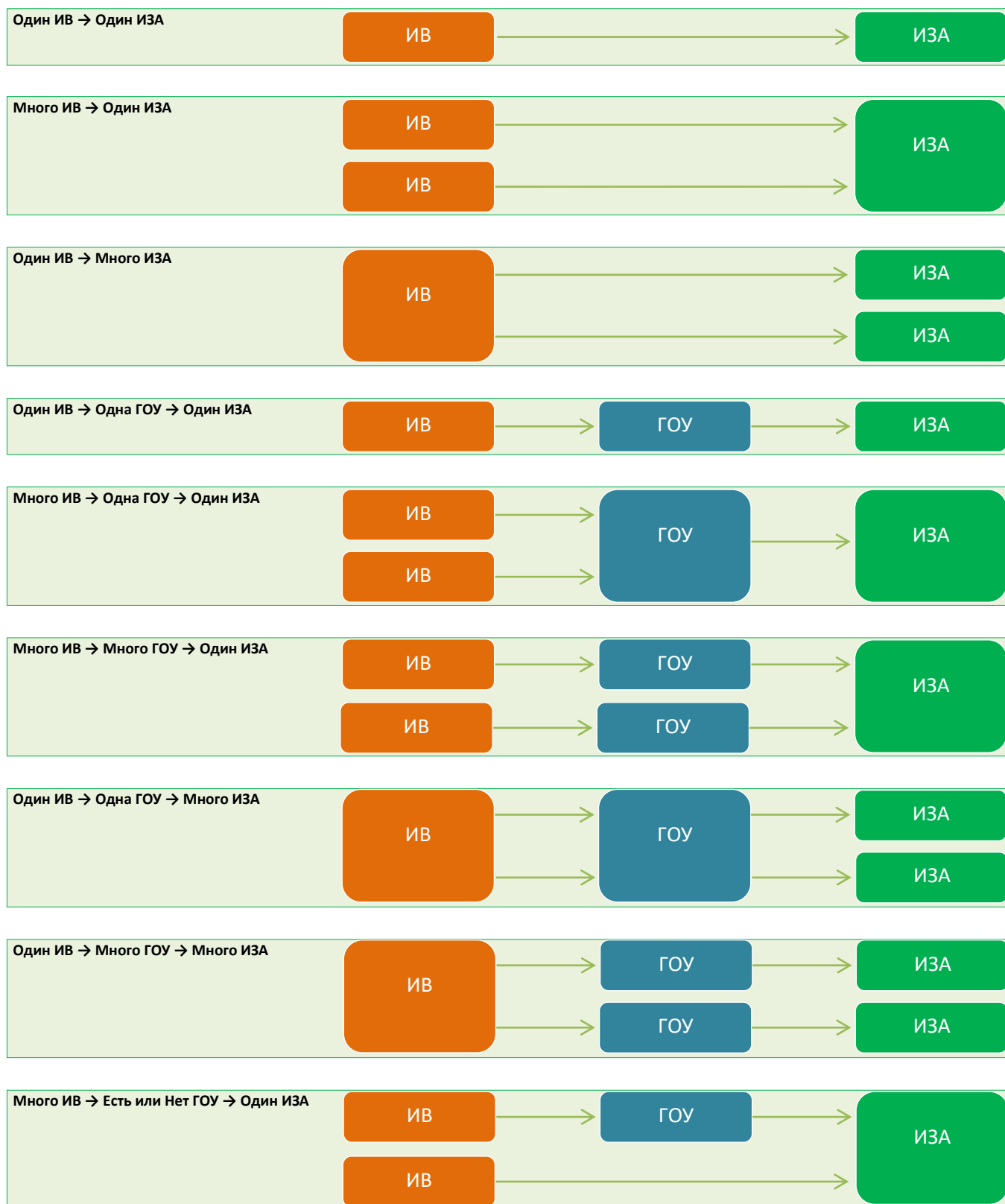
Рисунок 2.3 – Реализуемые программой распространенные схемы поступления загрязняющих веществ от источников выделения (ИВ) через опциональные газоочистные установки (ГОУ) в источники загрязнения атмосферы (ИЗА)
